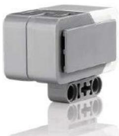
**Гироскопический датчик:** Цифровой датчик. В режиме «угол» меряет угловое точностью +/- 3 градуса; в режиме «гиро» вращения до 440 град/сек; автоматически встроенным ПО.
