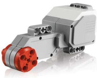
**2. Большой сервомотор:** Мощный мотор со встроенным датчиком угла поворота с точностью до 1 градуса; 160-170 об/мин; момент вращения 335 г\*см, момент удержания 670 г\*см; может быть синхронизирован с другим мотором для движения строго по прямой; автоматически распознается встроенным программным обеспечением.
