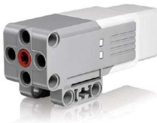
**3. Средний сервомотор:** Скорость вращения 240-250 об/мин; встроенный датчик угла поворота с точностью до 1 градуса; момент вращения 115 г\*см; момент удержания 170 г\*см; автоматически распознается встроенным программным обеспечением.
