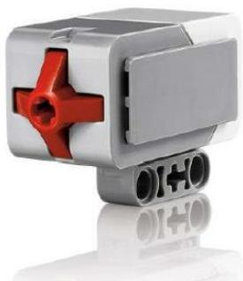
**5. Датчик касания (кнопка):** Определяет, нажата или отпущена кнопка, умеет подсчитывать одиночные и многократные нажатия; автоматически распознается встроенным программным обеспечением.
