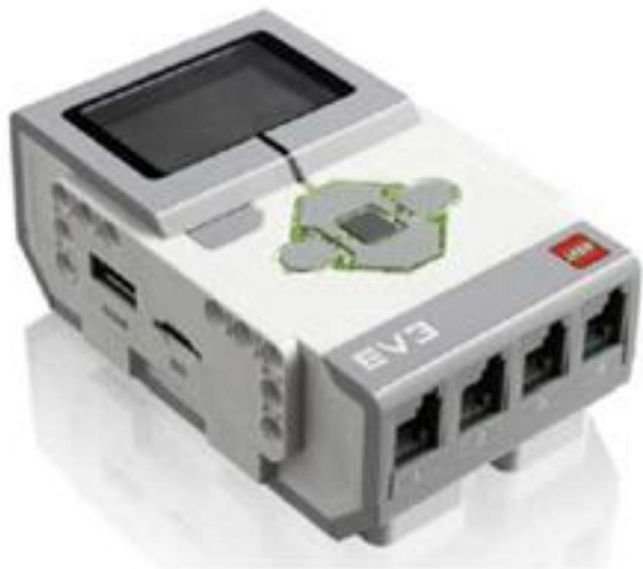
Микроконтроллер EV3 содержит 6 кнопок с LED-подсветкой, 4 порта для моторов, дисплей 178x128, слот для карт памяти mini SD, порт USB 2.0 тип A, Bluetooth, Wi-Fi, громкий динамик.
