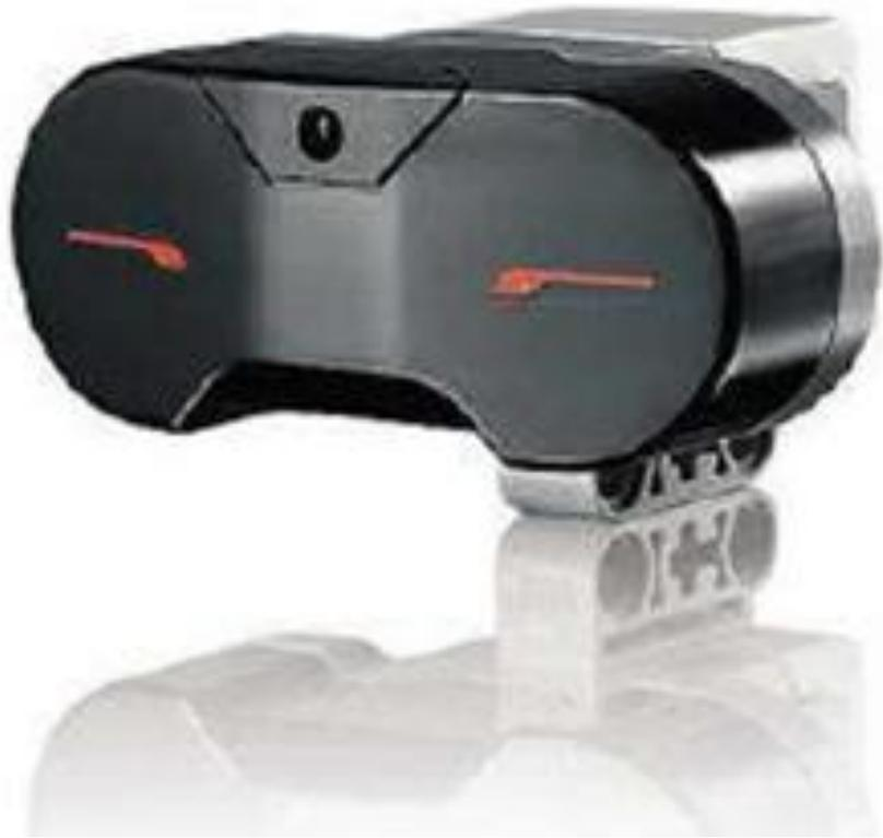
Цифровой инфракрасный датчик-поисковик определяет близость к роботу и считывает сигналы инфракрасного маяка. Близостью считается расстояние в 50-70 см. Рабочая дистанция от маяка до 2 метров. Поддерживает 4 сигнальных канала. Принимает команды с пульта управления. Автоматически распознается встроенным ПО.
