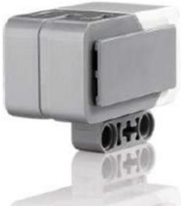
Цифровой гироскопический датчик. В режиме «угол» измеряет угловое положение с точностью  $\pm 3$  градуса; в режиме «гироскоп» измеряет скорость вращения до 440 град/сек; автоматически распознается встроенным ПО.
