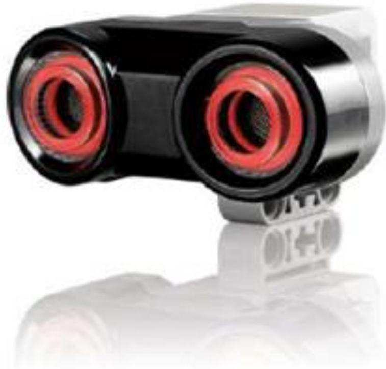
Измеряет расстояние до отражающего звук предмета в интервале 3-250 см с точностью +/- 1 см; может использоваться как датчик звука; индикатор светится непрерывно, когда датчик излучает, и мигает, когда слушает; автоматически распознается встроенным программным обеспечением.
