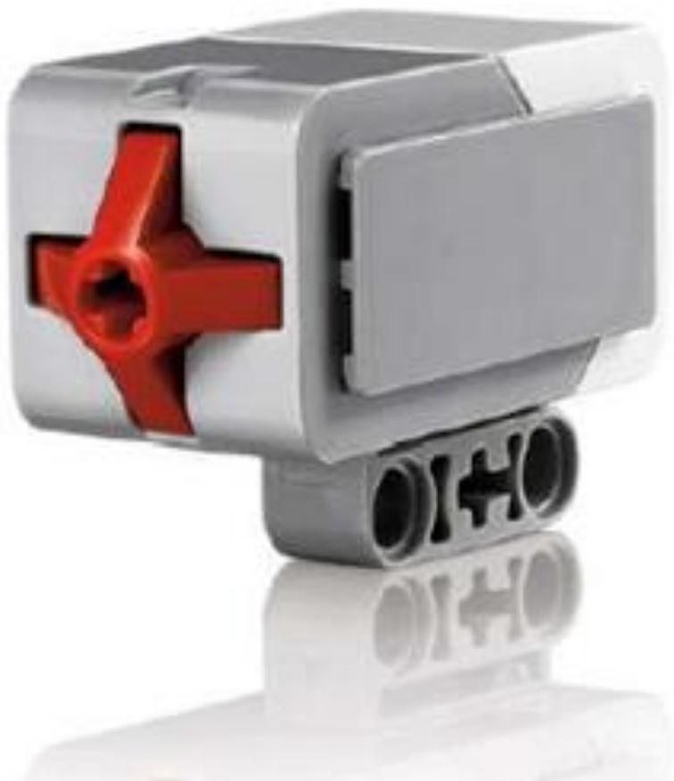
Определяет, нажата или отпущена кнопка, умеет подсчитывать одиночные и многократные нажатия; автоматически распознается встроенным программным обеспечением.
